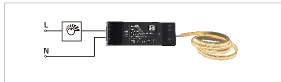
可控硅调光【连接示意图】 Triac Dimmer Connection diagram
